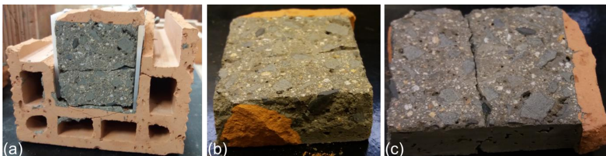
Figura 41 – Ruptura push-out com área de contato reduzida com bloco de 7 MPa. Fonte: Acervo da pesquisa
