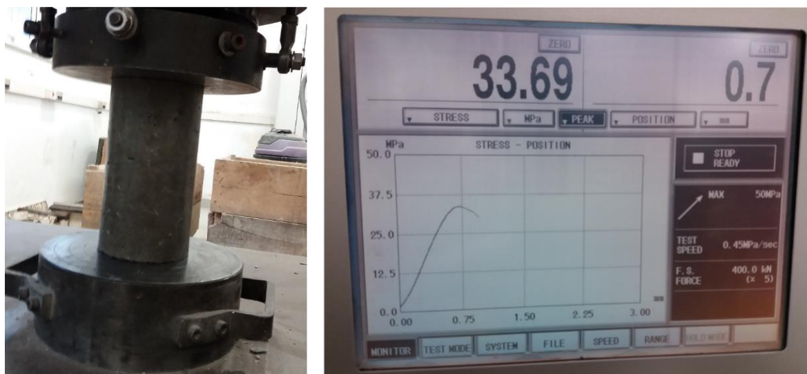
Figura 27 – Determinação da resistência à compressão do graute. Fonte: Acervo da pesquisa
