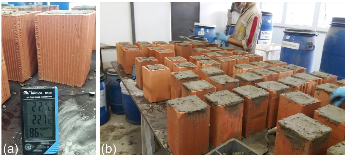
Figura 30 – Moldagem dos corpos de prova para push-out . Fonte: Acervo da pesquisa
