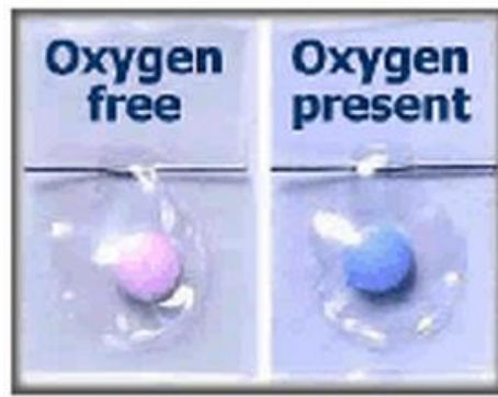
Figura 13. Exemplo de um sistema indicador de ausência/presença de oxigênio. Fonte: Adaptado de Vandesroost et al. (2014).
