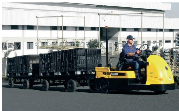
Figura 2 – Comboio formado por um rebocador elétrico, operadores de rebocador e duas bases sobre rodas.
