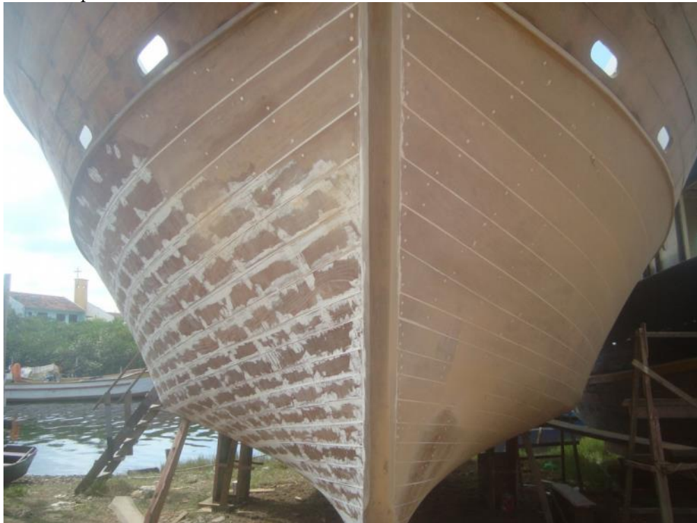
Figura 30: Casco parcialmente lixado.
