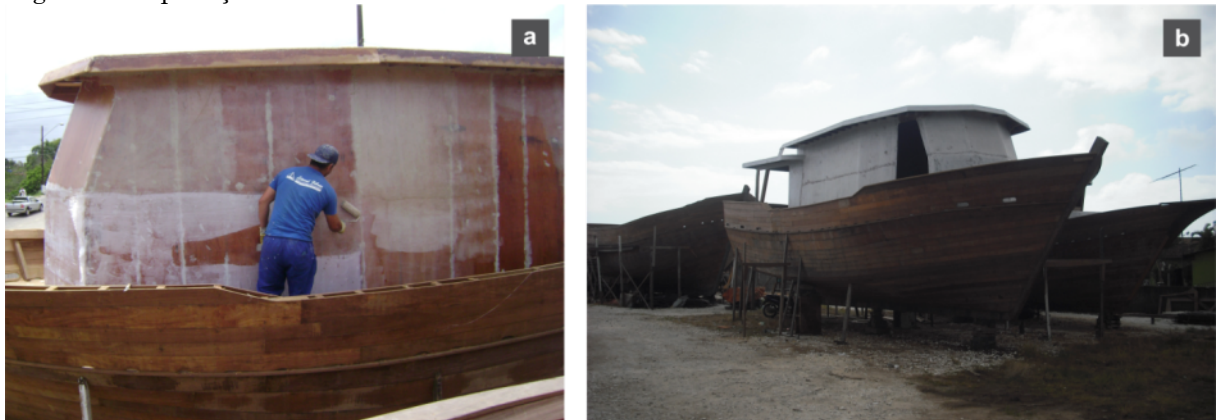
Impregnação de tecido com resina poliéster (a) e vista geral do trabalho concluído (b). Publicada em WALTER et al. (2017).
