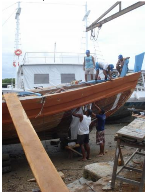
Figura 33: Aplicação de fibra de vidro + poliéster em saveiro em Cacha Pregos/BA.
