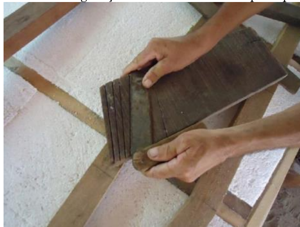
Figura 18: Tabuleta com molde de angulação de cavernas e suta para projeção do ângulo.
