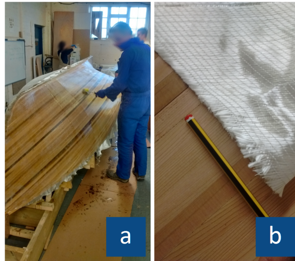
Laminação de tecido biaxial de fibra de vidro com resina epóxi sobre o casco composto de ripas de madeira (a) e detalhe do tecido biaxial sobre o casco de ripas antes da laminação (b).
