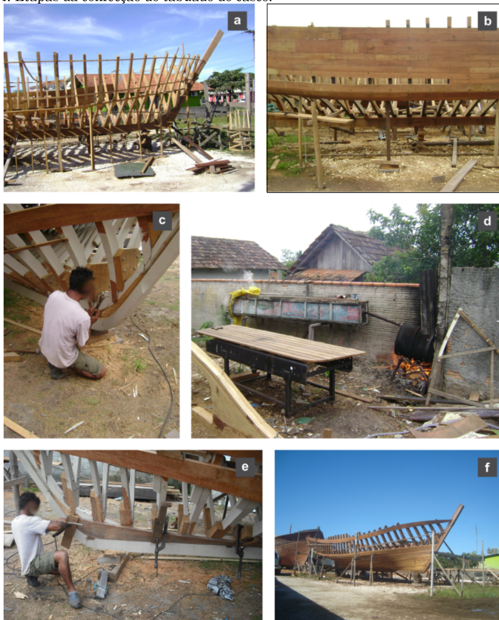
Cavernas e chine (a); costado (b); entalhe do resbordo (c); aquecimento com vapor (d); fixação do resbordo (e) e fundo (f). Publicada em WALTER et al. (2017).
