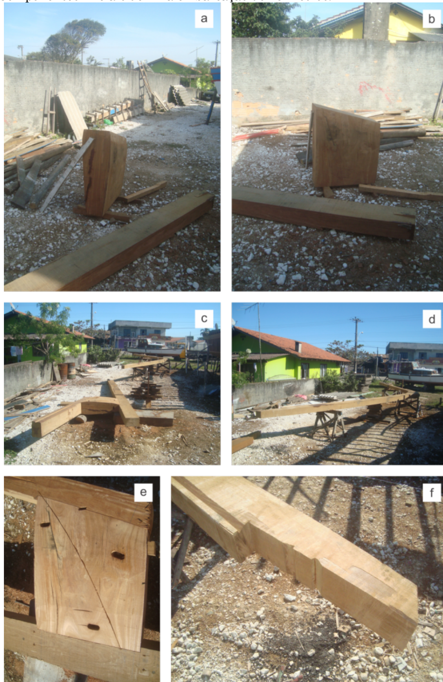
Patilhão em perspectiva (a) e vista lateral (b); montagem de quilha, patilhão e cadaste (c); quilha e talha-mar (d); detalhe de fixação do patilhão (e) e emenda da quilha (f).
