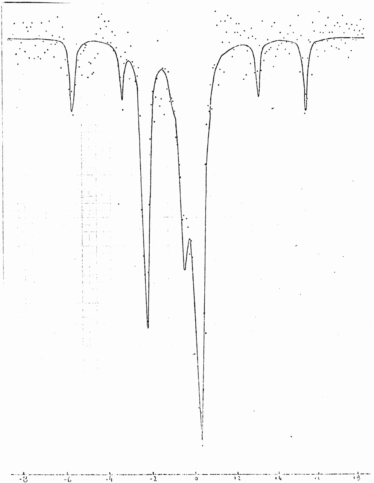
Figura 21 - Ajuste do espectro referente à amostra R_{3.8 \times 10^6} contagens por canal, flutuação estatística de 0,03%. \chi^2 = 1,14
