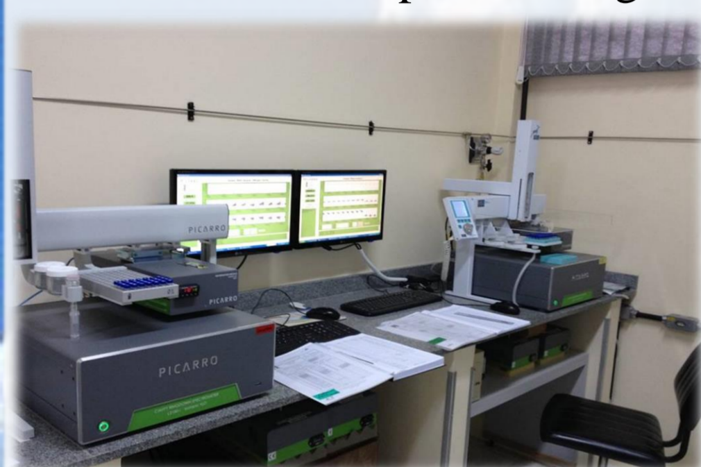
Espectrômetro a laser de cavidade ressonante tipo ring-down
