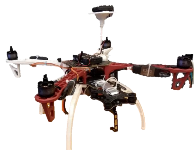
Figura 1 – Protótipo desenvolvido com a configuração de um quadricóptero.
