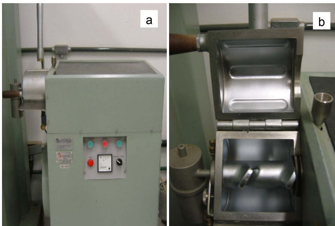
Figura 16 - Misturador Drais vista frontal (a) e interior do compartimento de mistura (b).
