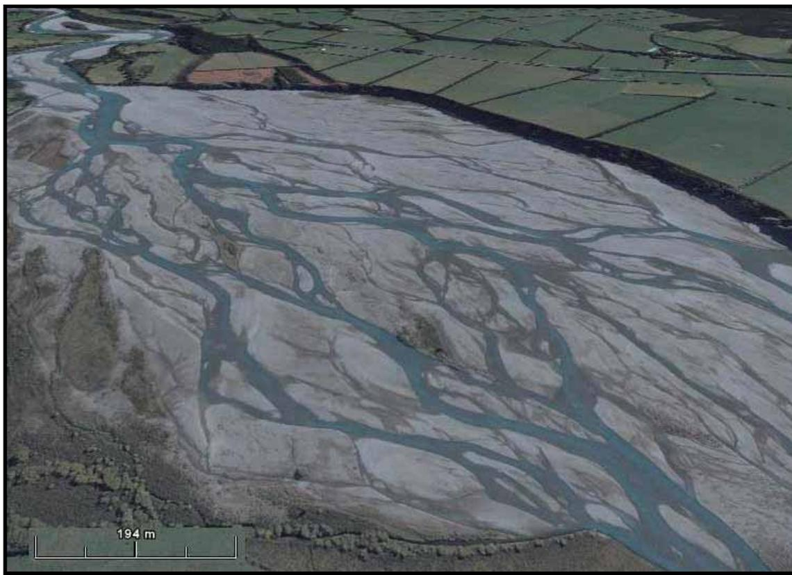
*Figura 2.19 - Imagem 3D do rio Waimakariri, Nova Zelândia, com canal do tipo entrelaçado, fonte Google Earth.*
