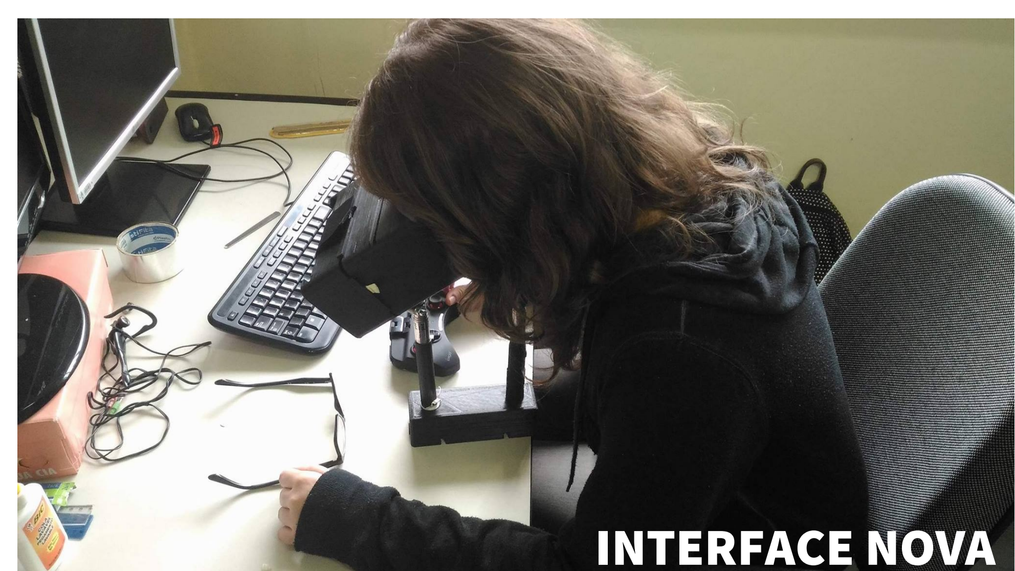
Figura 3: Interface nova, com apoio para queixo e hastes reguláveis que permitem que o usuário fique com as costas na posição correta
