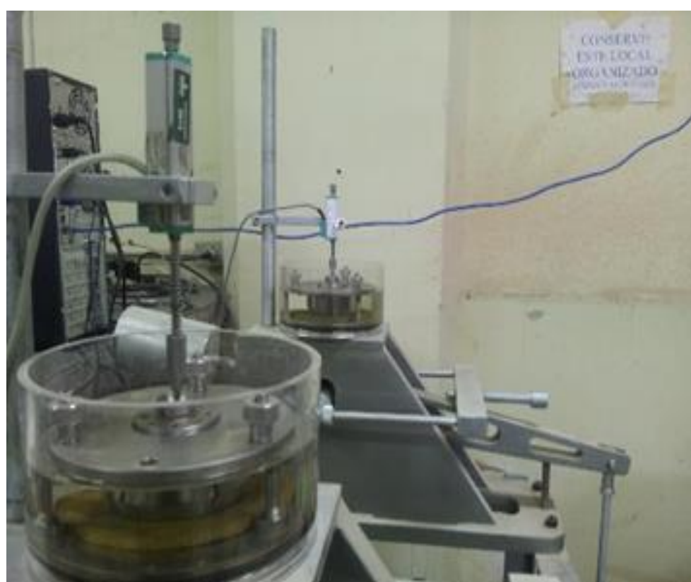
Figuras 1 - Aparato experimental dos ensaios de expansão.
