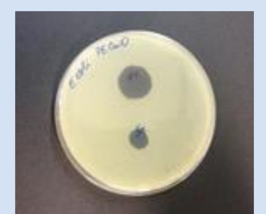
Figura 6. Placa de ágar após a retirada dos filmes de PECuO 1% e PECuO 5%
