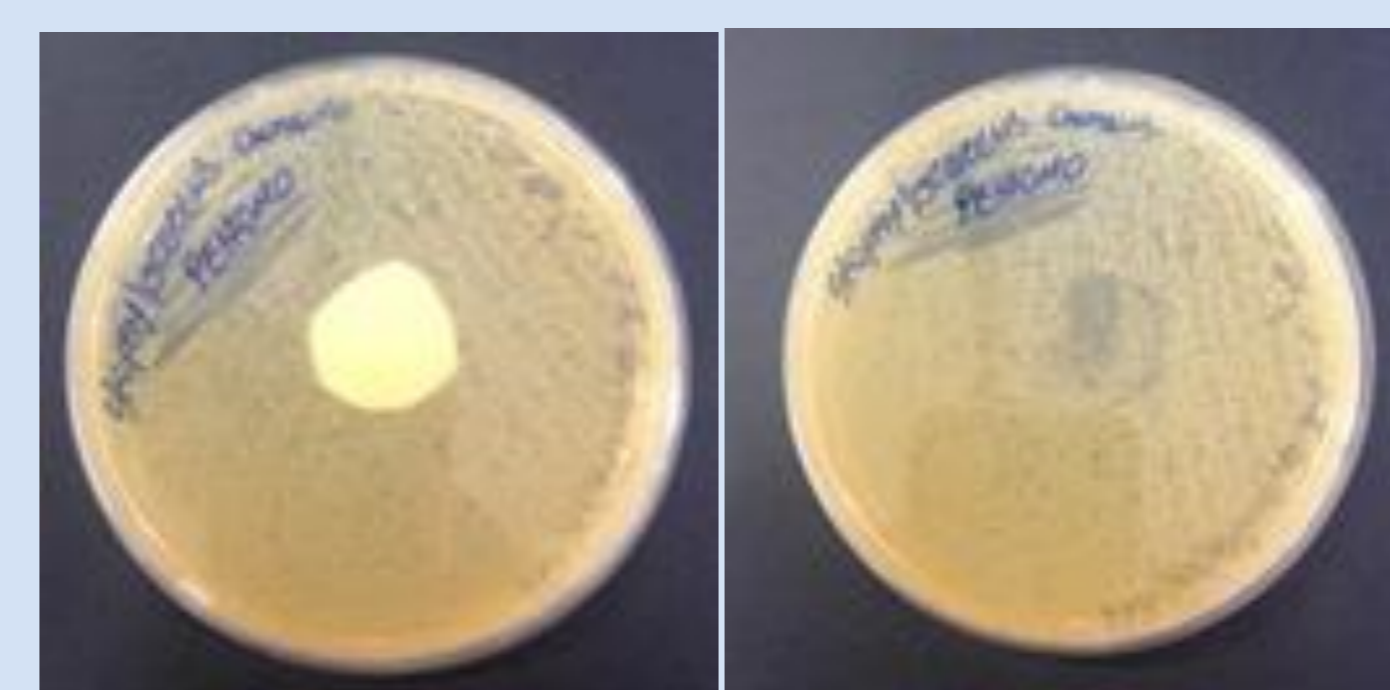
Figura 4. Teste antibacteriano para os nanocompósitos puros (sem carga)
