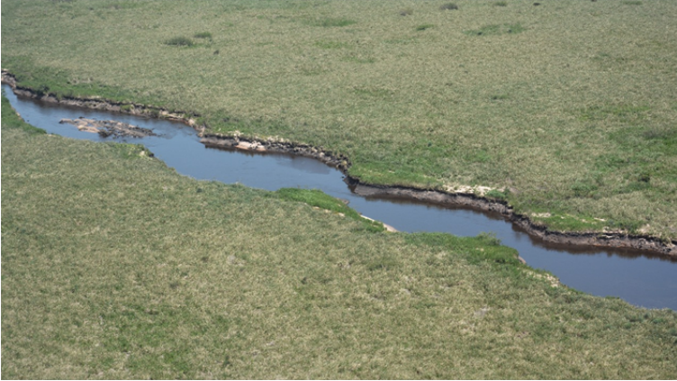
Figura 7. Fotografia aérea do trecho do canal de irrigação construído pelos agricultores locais no Banhado Grande ampliando o canal do DNOS. Este ponto, está em pleno processo de erosão, em que evidentes as formações circulares de erosão. Esse processo aumenta a vazão do fluxo hídrico entre o banhado e a planície de inundação do rio Gravataí. Foto: Jackson Müller, 16 nov. 2017.
