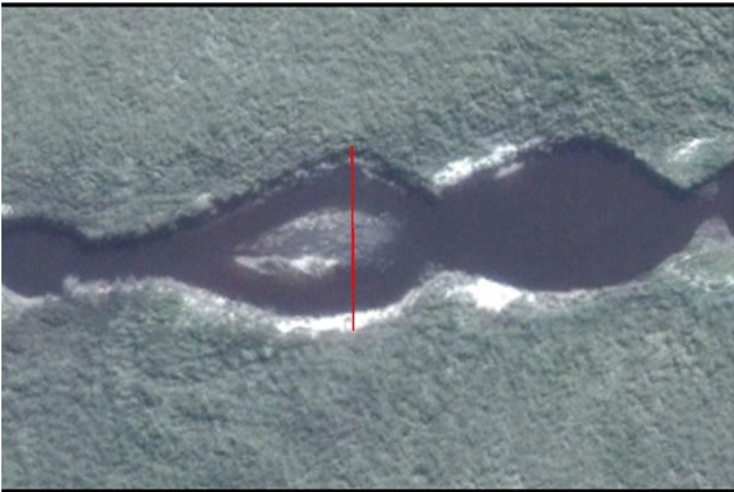
Canal de drenagem no banhado Grande em 2017 com 39,33 metros de largura
