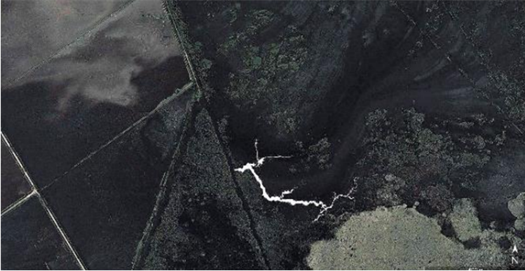
Figura 6. Imagem em período de grande pulso de inundação no Banhado Grande, setembro de 2012. O fluxo hídrico superficial, setor nordeste da imagem, evidencia concordância com a evolução da voçoroca. O ponto de ruptura da voçoroca ocorre no contato do fluxo superficial com o trecho retificado perpendicular do rio Gravataí. Fonte: Google Earth Pro .
