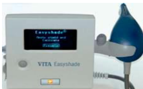
Figura 2 – Espectrofotômetro Vita Easyshade/Vita utilizado para análise quantitativa de cor
