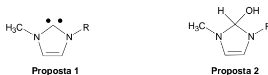
Figura 28 Propostas de espécies formadas a partir da reação do cátion imidazólico com água.
