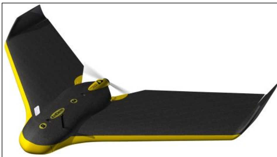
Figura 9 – VANT eBee e suas principais características externas.
