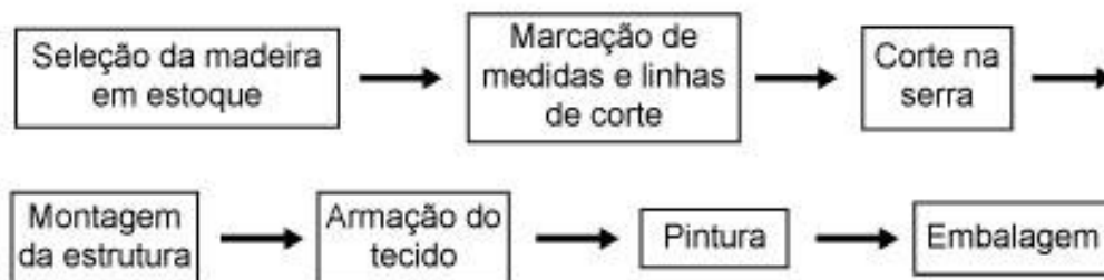
Figura 19 - Processo de produção de telas
