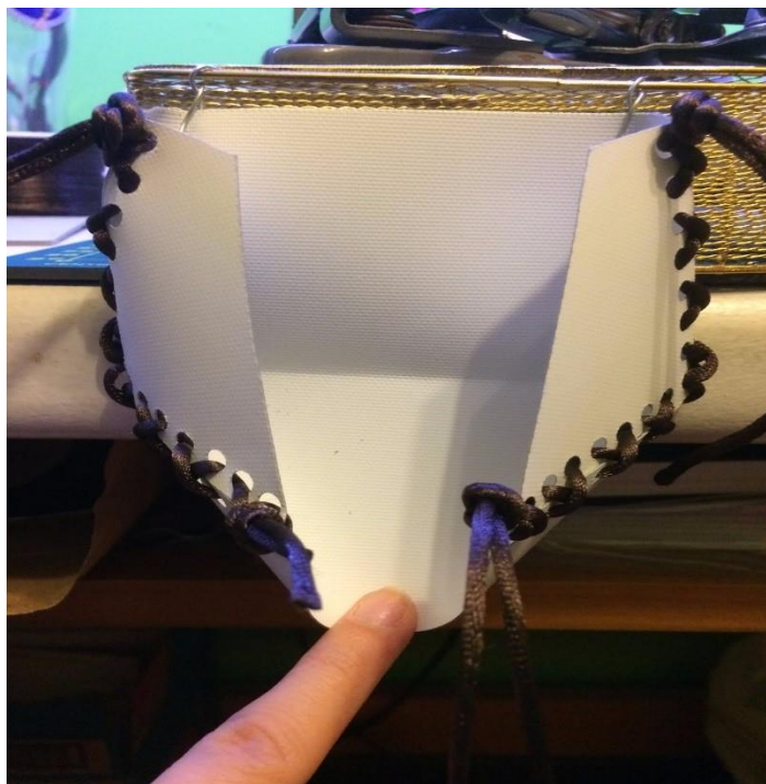
Figura 27 - Módulo abaulado com a aplicação de carga.
