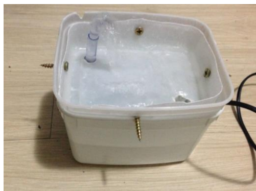
Figura 10 – Modelo utilizado no teste de variação de temperatura em um sistema de água circulante.
