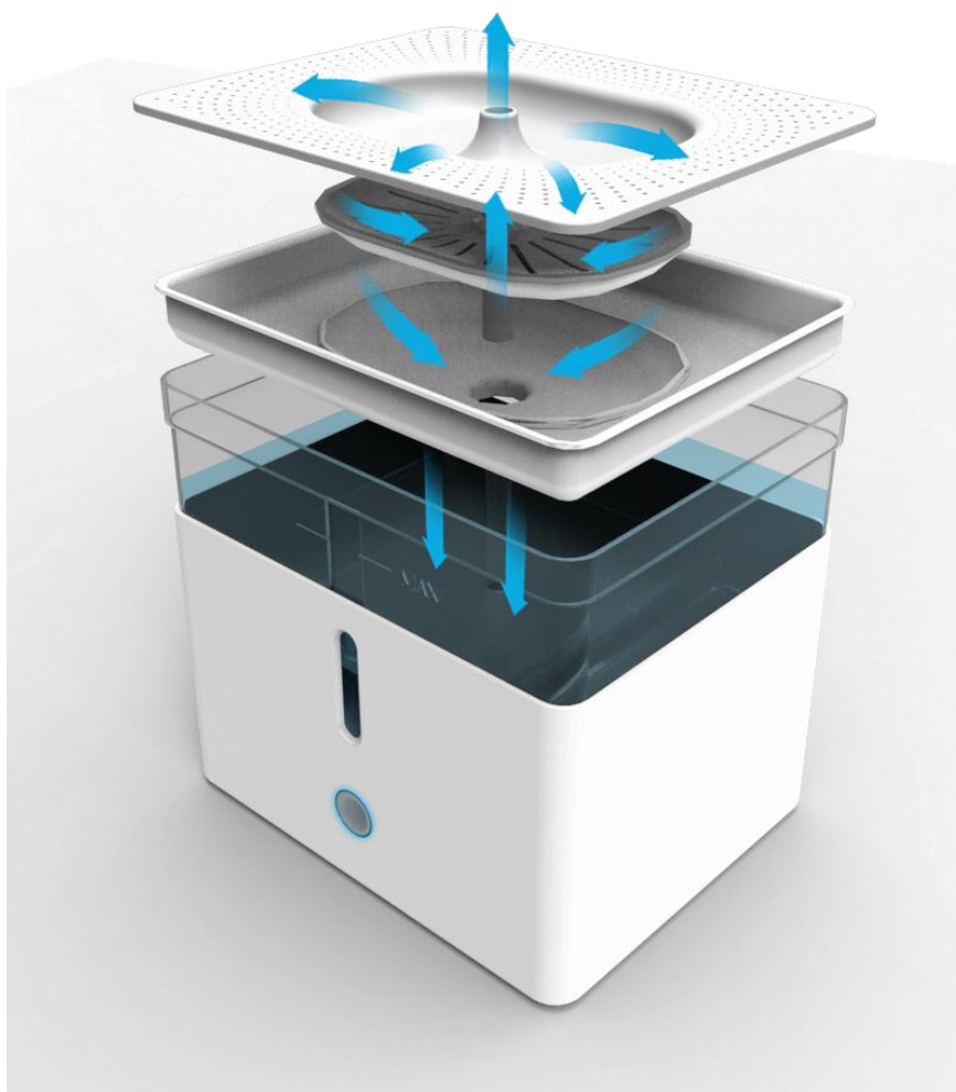
Figura 39 – Fluxo da água no bebedouro.
