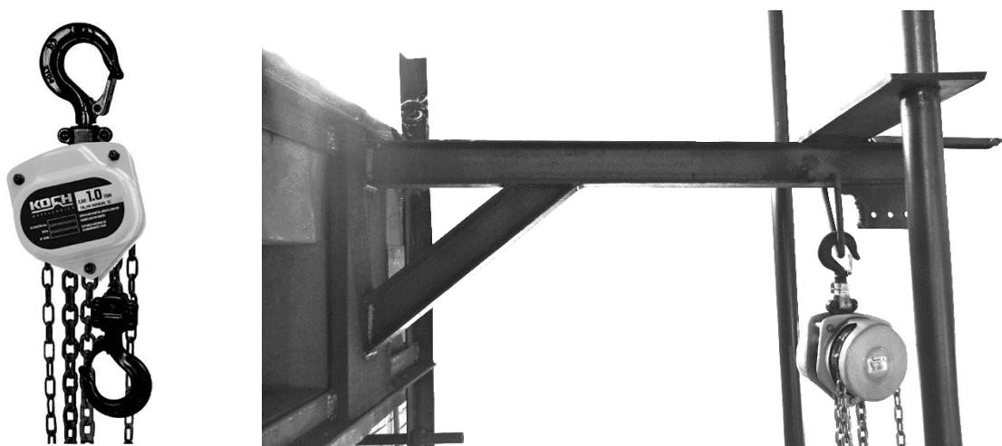
Figura 30: talha utilizada para içamento do bloco (esq.) e conjunto montado (dir.)
