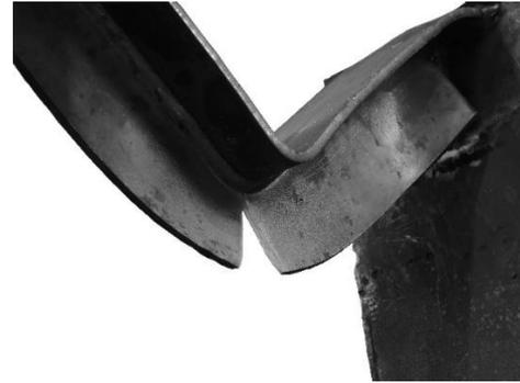
Figura 48: Deflexão nas vigas "longas" (esq.) e ruptura da alma do perfil "T" CP2 (dir.)
