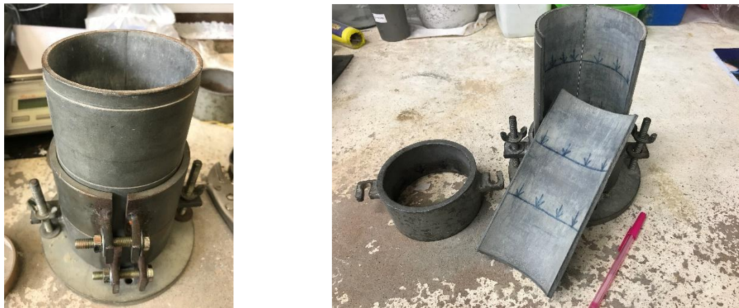
Figura 3.5: Molde metálico tripartido utilizado na moldagem dos corpos de prova
