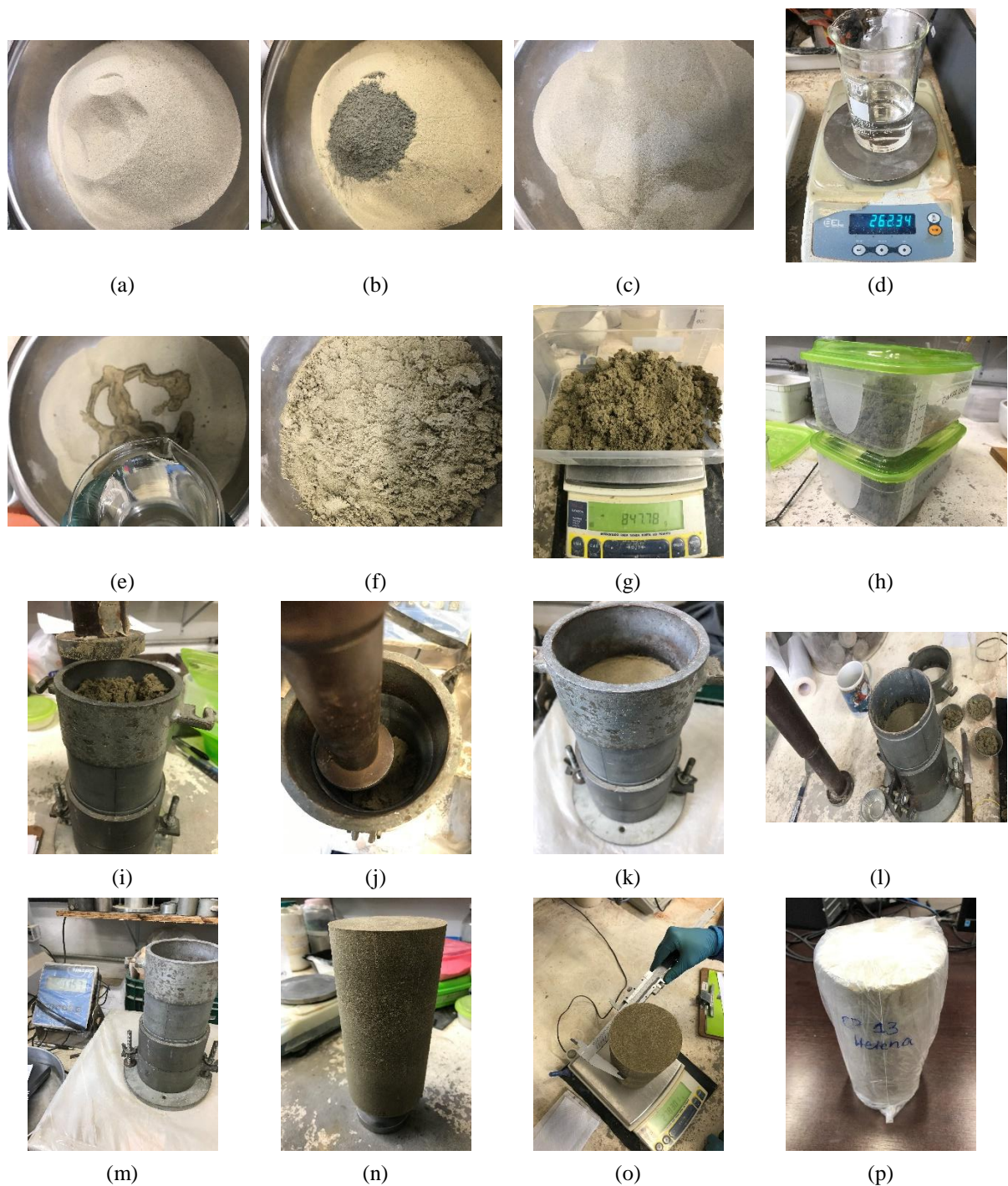
Figura 3.6: Procedimento de moldagem de um corpo de prova
