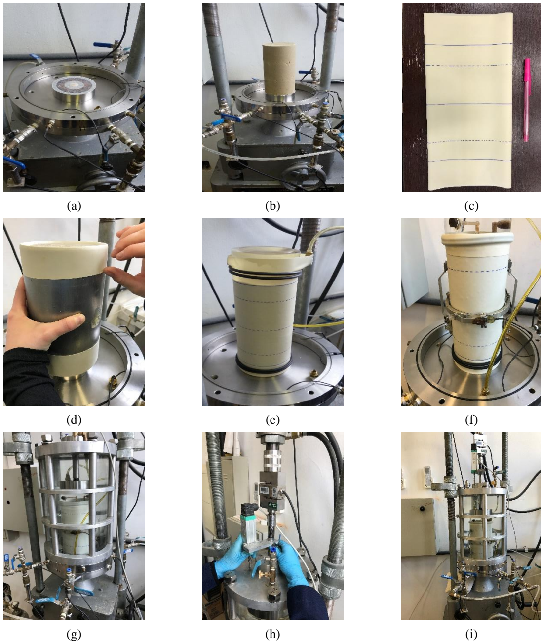
Figura 3.8: Procedimento de montagem do ensaio triaxial
