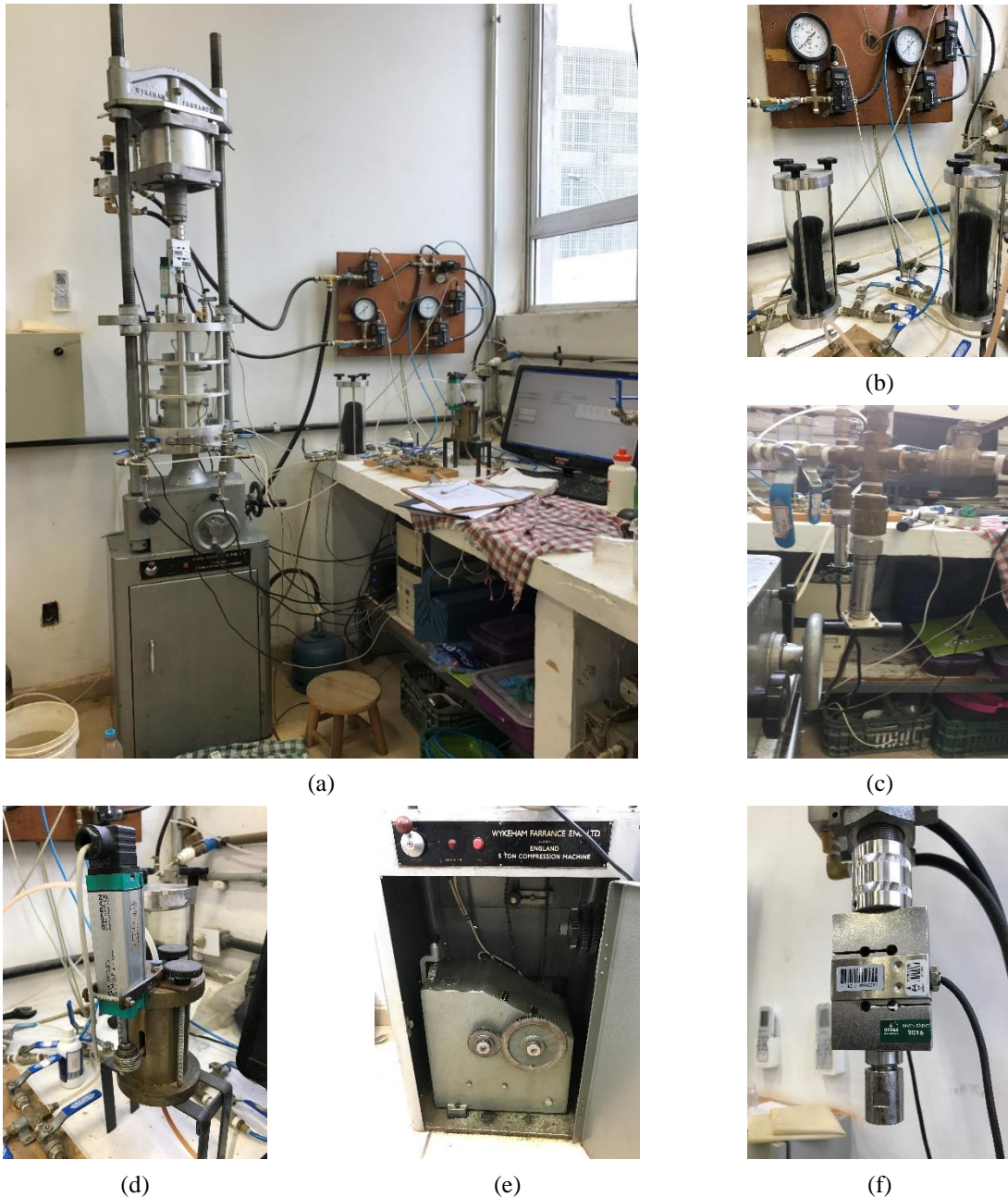
Figura 3.7: Equipamento triaxial utilizado
