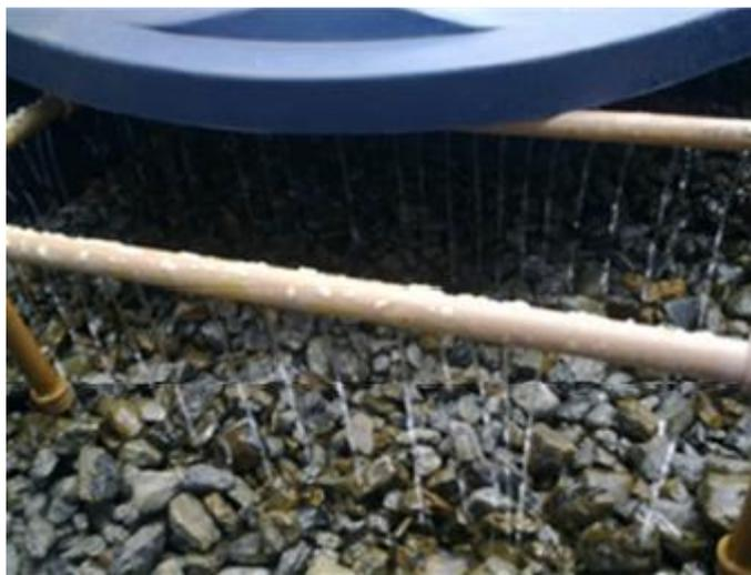
**Figura 12.** Etapa aeróbica da lixiviação do concentrado de pirita.
