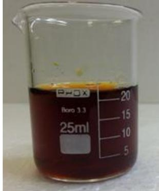
**Figura 25.** Coagulante produzido a partir de 5 g de sulfato ferroso, 7,5 ml de água destilada, 0,25 mL de ácido sulfúrico e 1,5 mL de H<sub>2</sub>O<sub>2</sub>.
