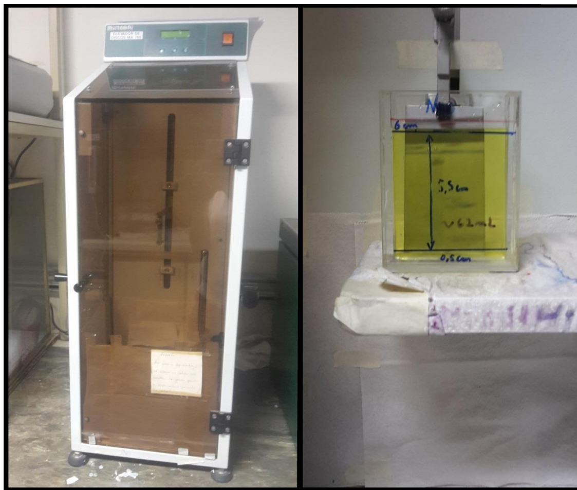
Figura 8. Imagem a esquerda: dip-coating . Imagem a direita: célula de deposição dentro do dip-coating .
