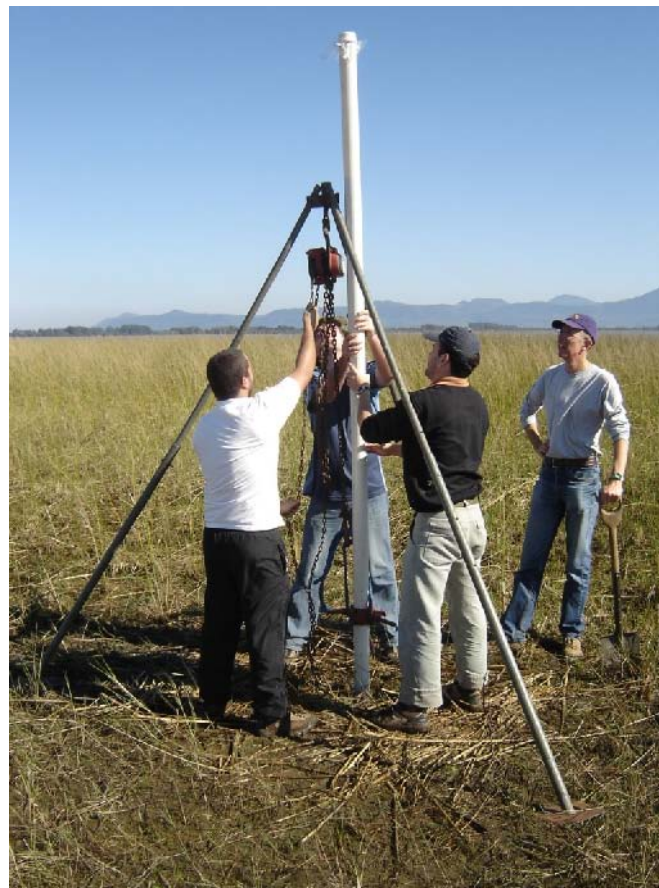
Figura 6.1.3 – Processo de retirada do testemunho com o auxílio de tralha manual.
