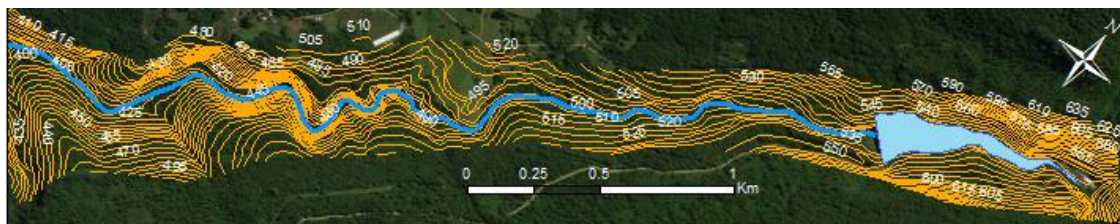
Figura 3– Levantamento Topográfico a Jusante da Barragem de Canastra
