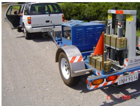
Figura 58: Equipamento FWD utilizado no estudo. Fonte: Registro fotográfico do autor
