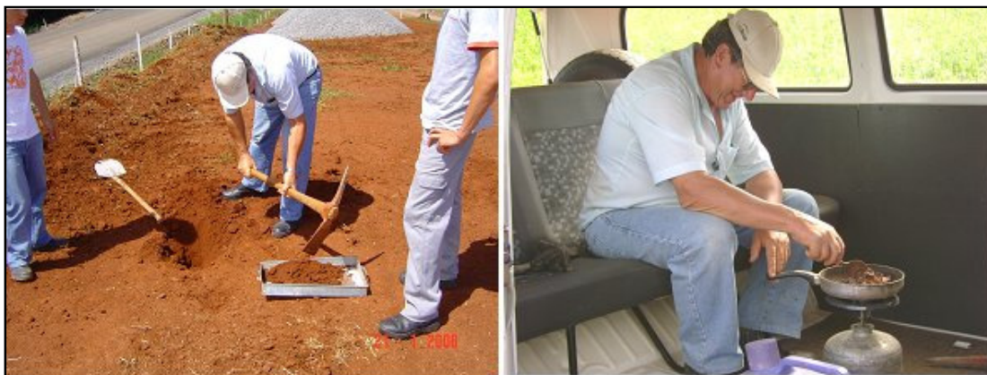
Figura 42: coleta de amostra na jazida
