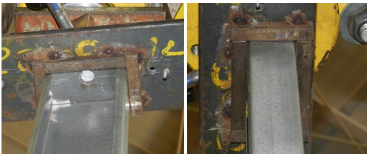
Figura 5.4 – Sistema de fixação superior dos perfis
