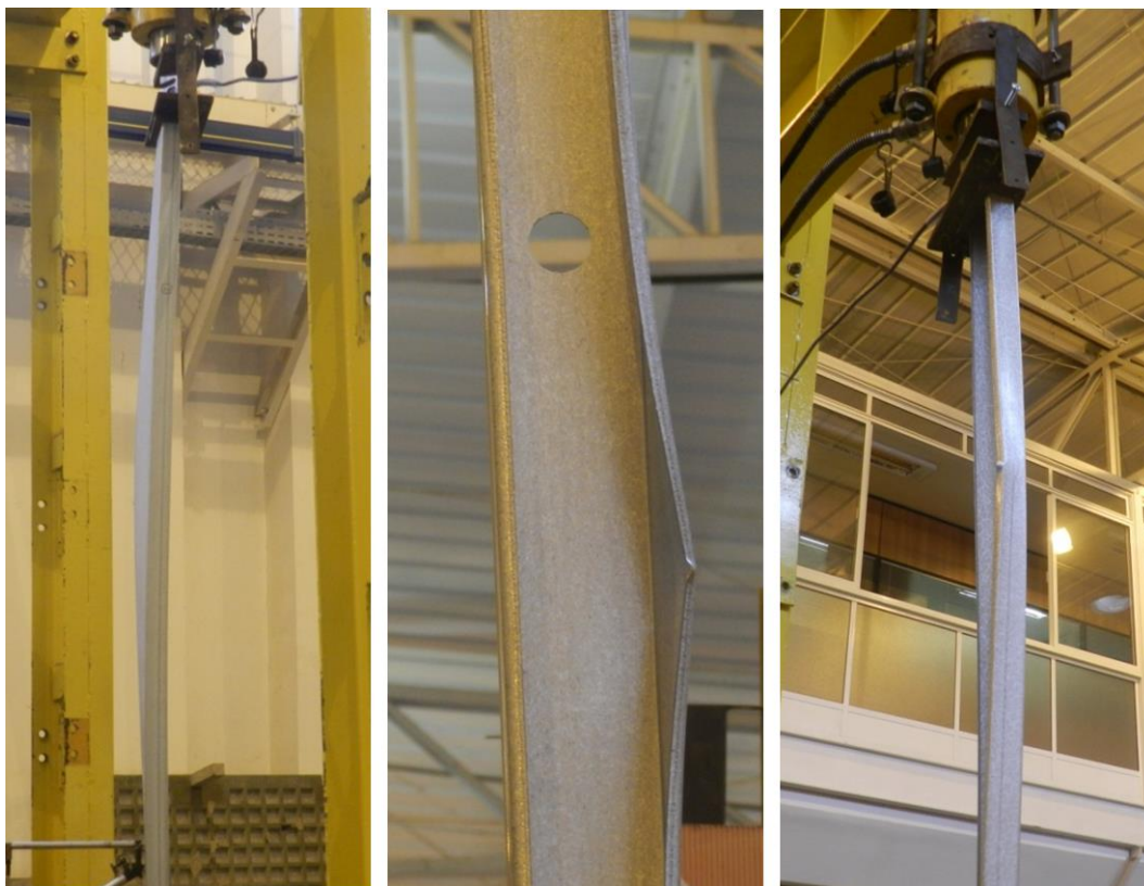
Figura 5.13 – Modos de falha identificados nos corpos de prova: flambagem global, local e local, respectivamente
