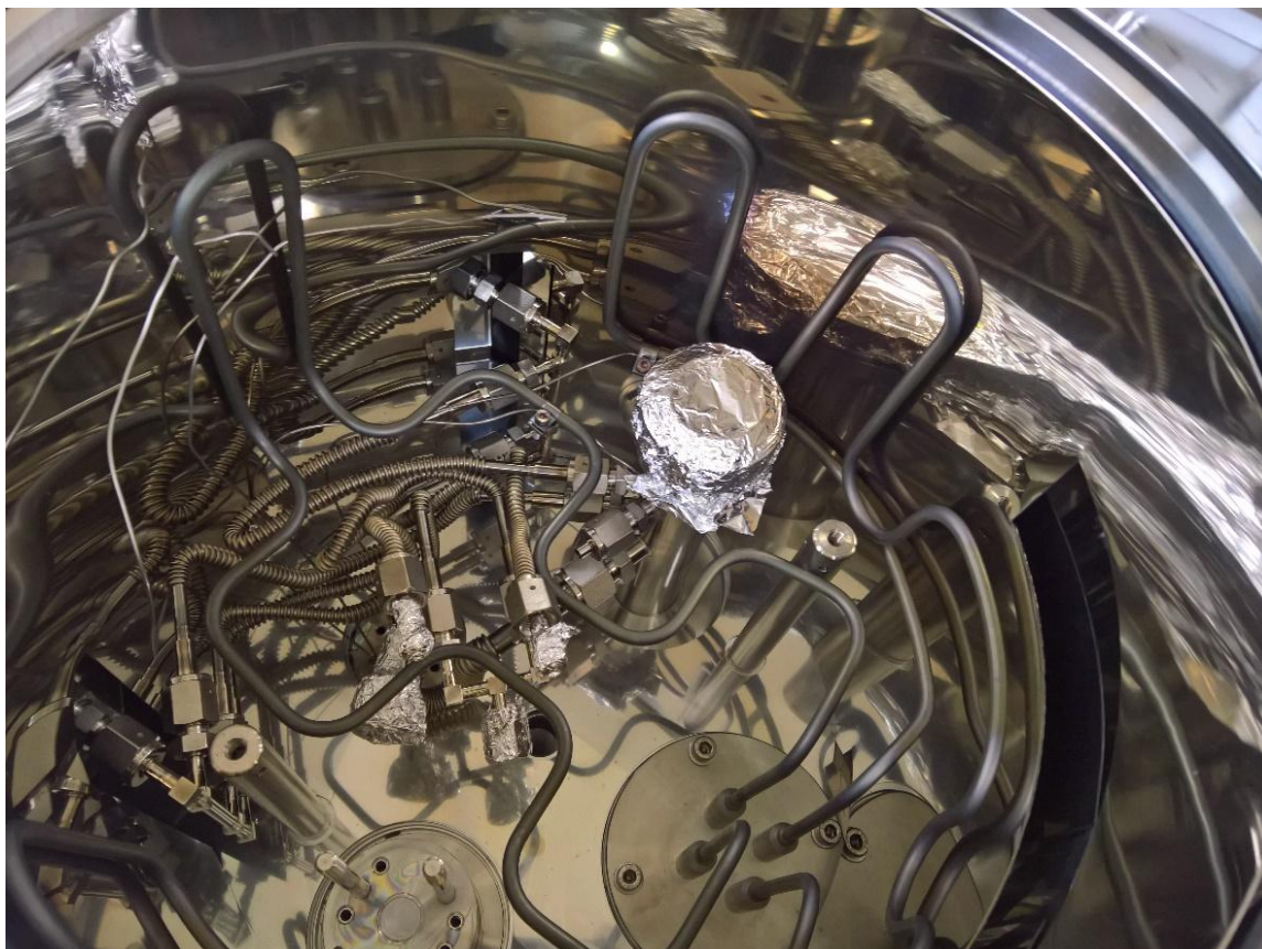
Figura 12: Foto da câmara interna do reator durante a manutenção do equipamento de ALD
