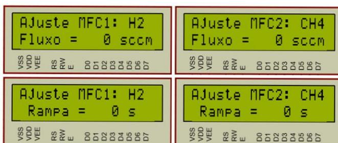
Figura 22: Telas de ajuste de vazão e rampa para cada gás.
