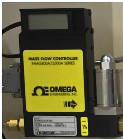
Figura 13: MFC modelo FMA 5500A da marca Omega.
