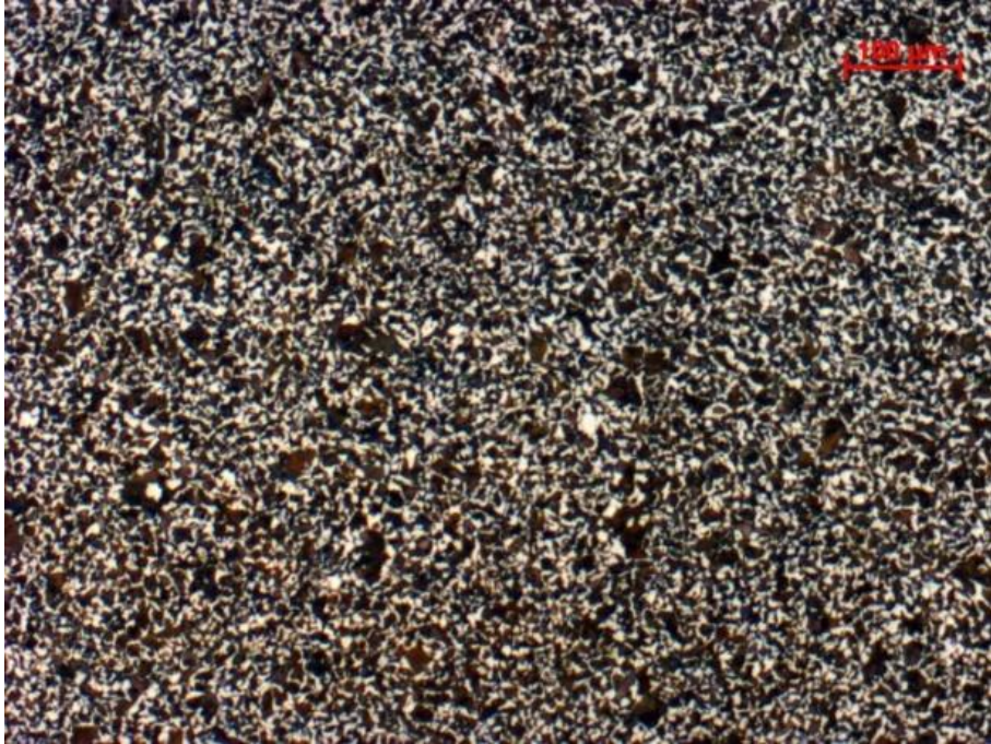
Figura 42: Metalografia do SAE 1045H após resfriamento em esteira. Microestrutura formada por perlita e ferrita refinada. Aumento de 100x, ataque nital 4%.
