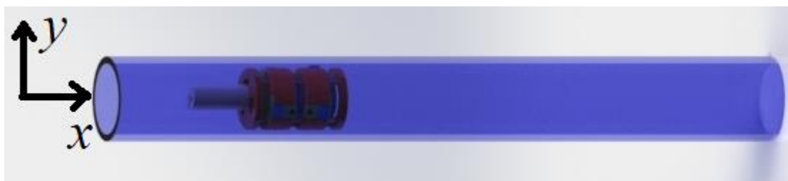
Figura 16: Eixos de referência dos movimentos do robô.
