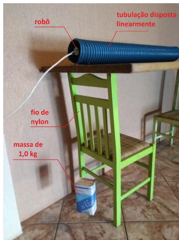
Figura 23: Teste de capacidade de carga.
