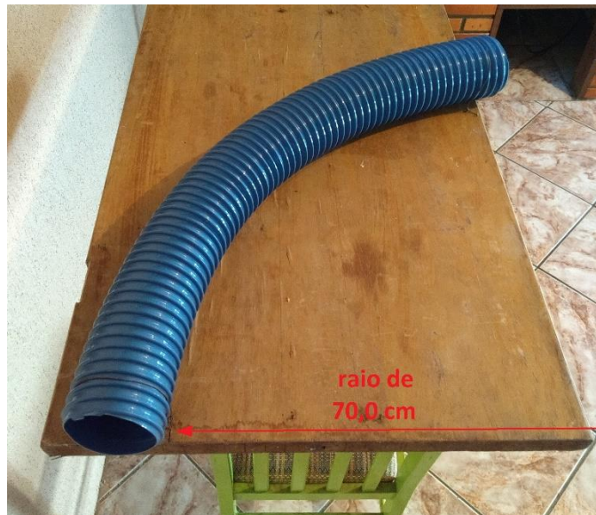
Figura 24: Teste de capacidade de movimento curvilíneo.
