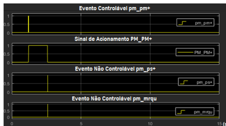
Figura 6.5 – Evento controlável de avanço pm_pm+ e seu sinal, PM_PM+, junto aos eventos não controláveis pm_ps+, de fim de curso e pm_mrqu.
