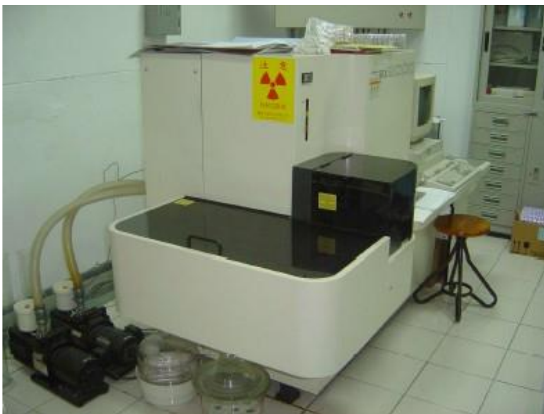
Figura 16: espectrômetro de Fluorescência de raios X Rigaku, modelo RIX-2000, usado para as análises de FRX no Laboratório de Espectrometria por Fluorescência de Raios X do CPGq-IGEO-UFRGS.
