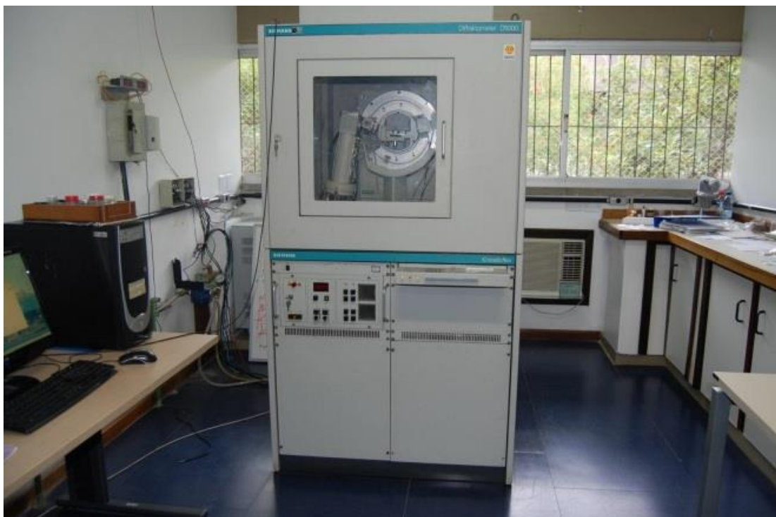
Figura 15: difratômetro de raios X Siemens Bruker D-500, no qual foram analisadas as amostras selecionadas.
