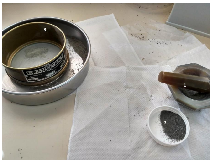
Figura 13: materiais usados na moagem manual das amostras. 1) graal e pistilo de ágata; 2) porção com granulometria areia grossa; 3) peneira sieve mesh 200.
