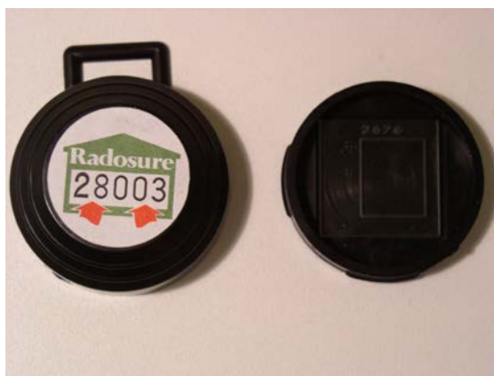
Figura 13 - Detectores tipo traços, que consistem, essencialmente, numa pequena câmara circular, contendo um pedaço de plástico.
