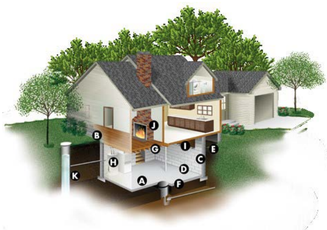
Figura 4 - Principais vias de entrada de radônio em residências.
