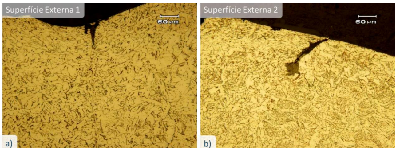
Figura 5.5: Superfícies externas de solda 1 e 2, apresentando defeitos na solda.
