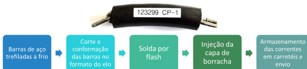
Figura 1.2: Processo de fabricação das correntes de compensação.
