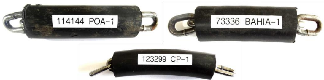
Figura 5.1: Corpos de prova utilizados nos ensaios de tração da corrente.
