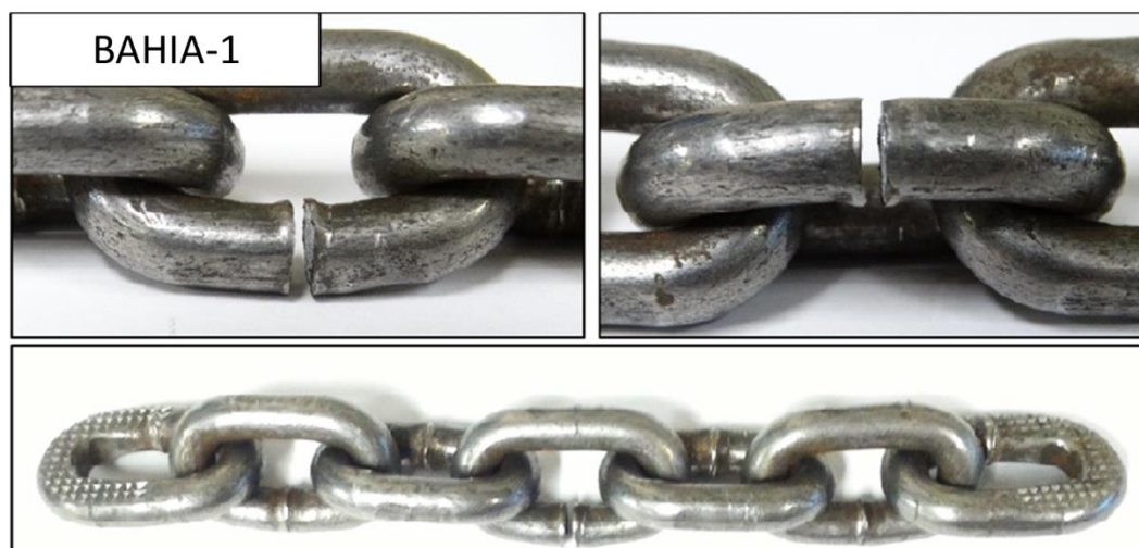
Figura C.2: Corpo de prova BAHIA – 1 dissecado após tração e ruptura.
