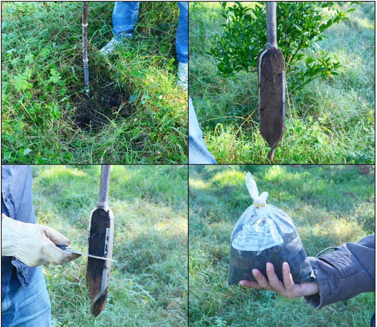
Figura 7. Coleta de solo com o trado holandês. Retira-se o excesso de amostra coletada pelo trado, antes do armazenamento da mesma
