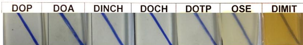
Figura 51 - Indicação visual da transparência dos compostos de PVC.
