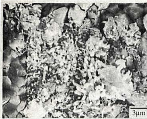
Abb. 35: Zersetzung der äußeren Sulfidschicht im REM nach 30s-Elektronenbestrahlung. (AgAu20, 20h, \epsilon = -480\text{mV} , 2\text{M NaOH} + 9,3\text{mmol/l HS}^- ).
