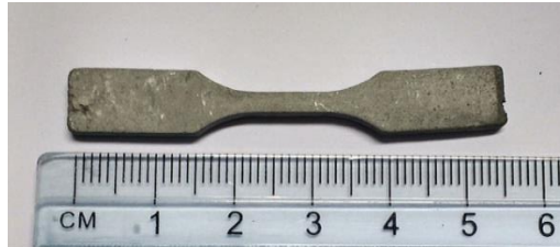
Figura 68: Amostra 60-40BN/60CC com distorção causada durante a sinterização.
