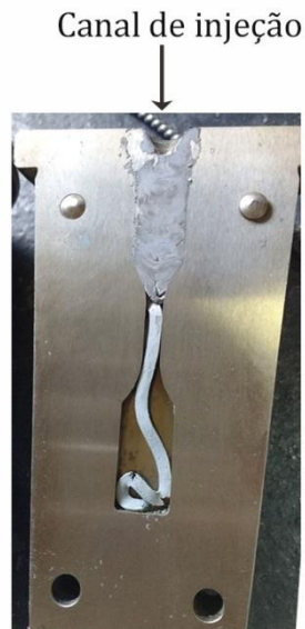
Figura 44: Carga injetável contendo 63% vol. e ligante 67BN/33CC.
