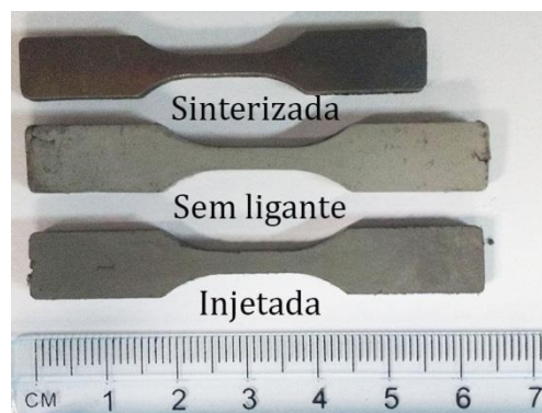
Figura 66: a) Amostra injetada, b) após extração térmica e c) sinterizada.
