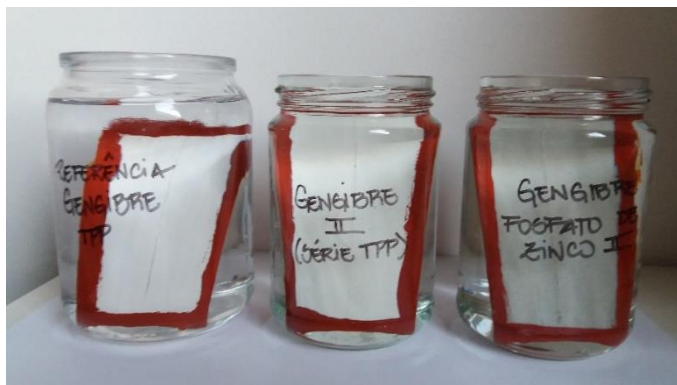
Figura 27. Imagem fotográfica do ensaio de imersão estático para avaliação da resistência a corrosão das tintas.
