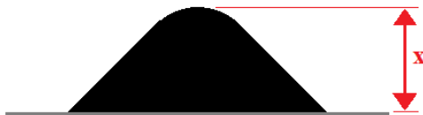
Figura 29. Desenho esquemático da medida da expansão da camada carbonosa.
