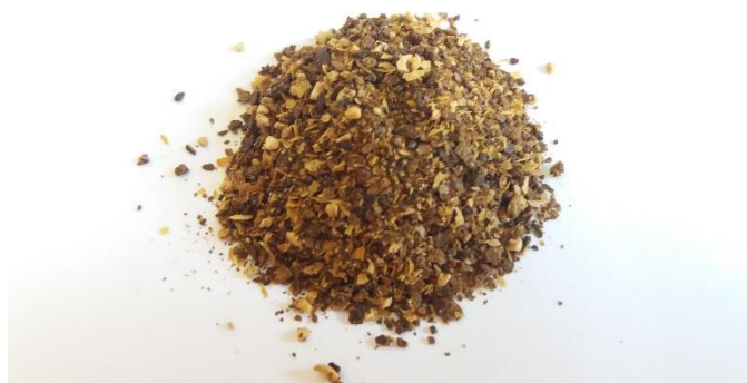
Figura 33. Imagem fotográfica da casca de café após a moagem em moinho de facas.
