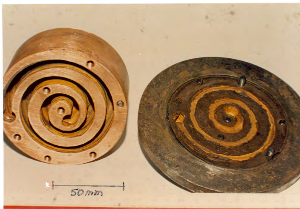
FIGURA 26 - Base de cobre refrigerada, aberta para evidenciar o canal do fluxo de água.
