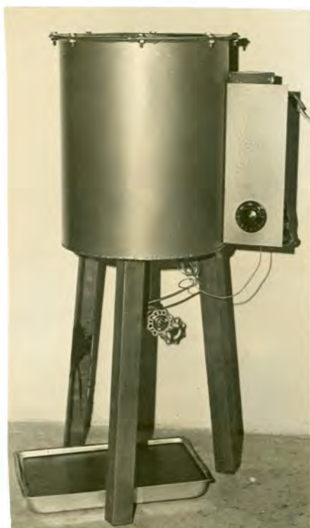
FIGURA 27 - Forno elétrico, utilizado para fabricação das misturas de ceras.
