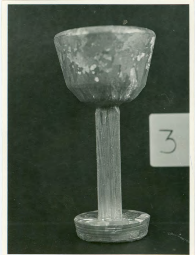
FIGURA 47 - Macrografia externa dos CP's mostrando a influência da temperatura de superaquecimento ( T_{sup} ) sobre o grau de direcionalidade para o caso de Al puro bruto de fusão CP1 T_{sup}=30^{\circ}\text{C} ; CP2 T_{sup}=78^{\circ}\text{C} ; CP3 T_{sup}=134^{\circ}\text{C} ; CP4 T_{sup}=159^{\circ}\text{C} . Ataque: água régia fluorada.
