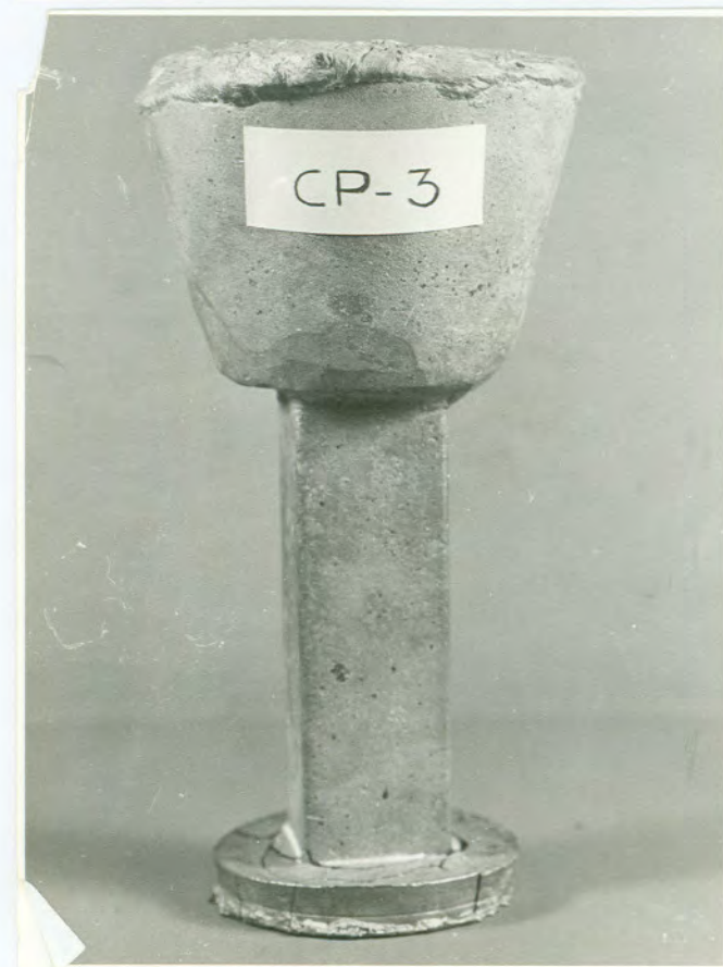
FIGURA 49 - Aspecto superficial de alguns dos corpos de prova de Alnico, bruto de fusão, logo após a desmoldagem.
