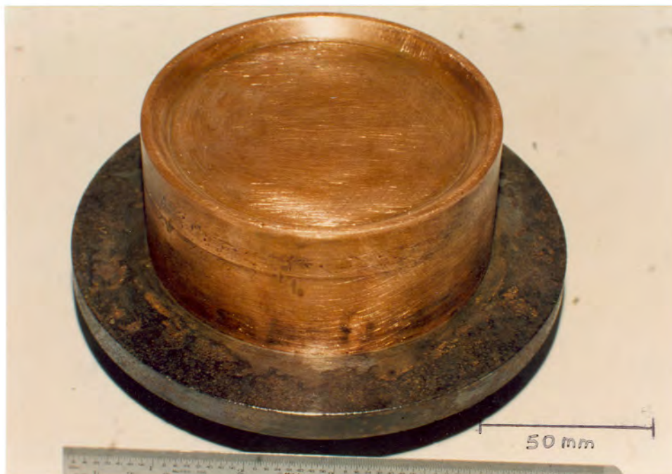
FIGURA 25 - Base de cobre refrigerada, construída especialmente para este trabalho.
