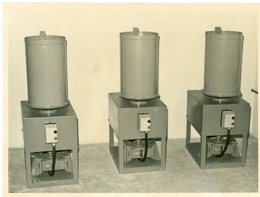
FIGURA 31 - Misturadores usados na fabricação das lamas cerâmicas.
