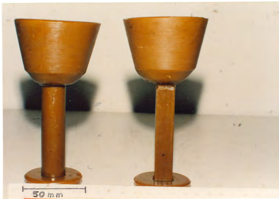
FIGURA 30 - Árvores de modelos em cera, usadas nas primeiras experiências.
