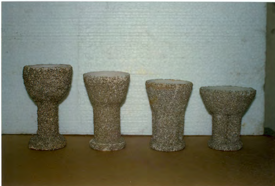
FIGURA 41 - Aspecto de algumas cascas cerâmicas utilizadas neste trabalho após a deceragem e calcinação
