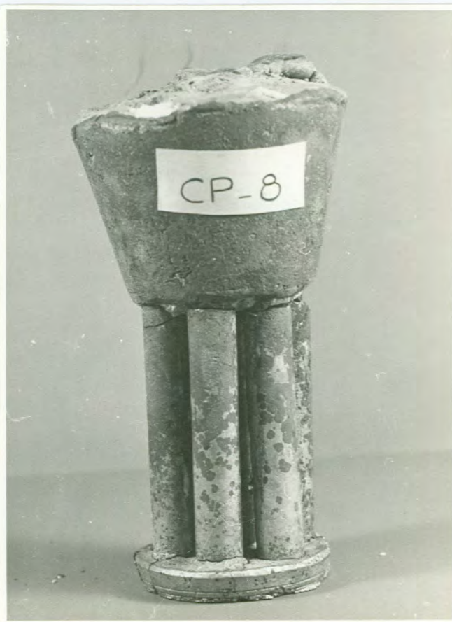
FIGURA 49 - Aspecto superficial de alguns dos corpos de prova de Alnico, bruto de fusão, logo após a desmoldagem.
