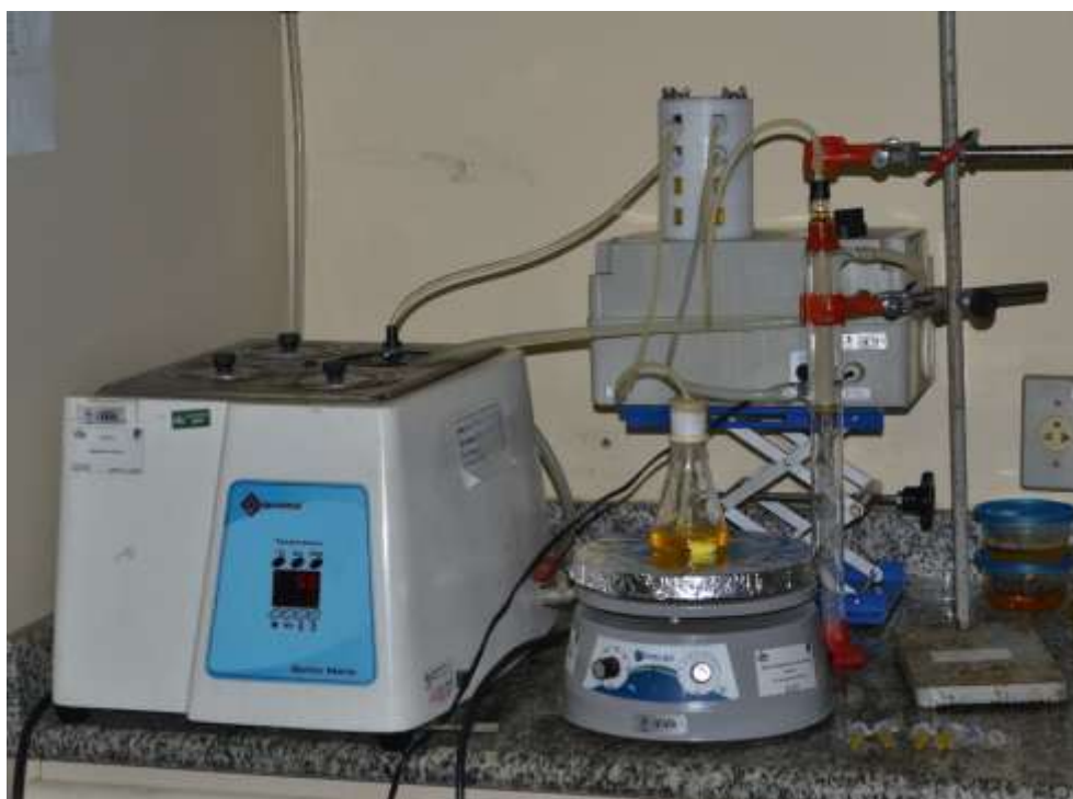
Figura 17 - Aparato experimental utilizado na síntese do poliol
