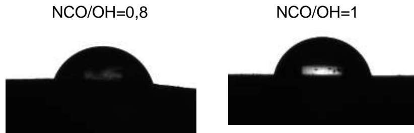
Figura 29 - Determinação do ângulo de contato estático dos filmes de PU sintetizados nas razões NCO/OH de 0,8 (a) e 1 (b)
