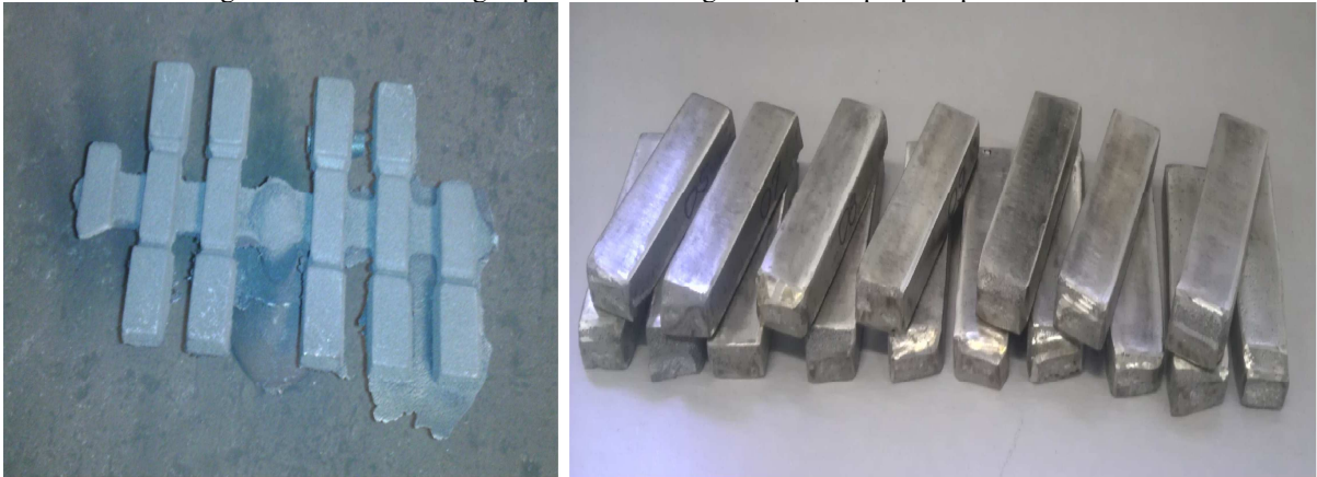
Figura 53– Amostras logo após a desmoldagem e após o preparo para os ensaios
