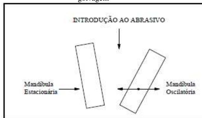
Figura 18– Representação esquemática de um britador de mandíbulas para o ensaio de abrasão por goivagem
