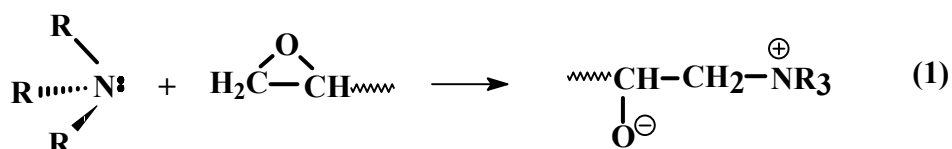
Figura 17 - Mecanismo da reação de cura do sistema epóxi /anidrido. 31,47
