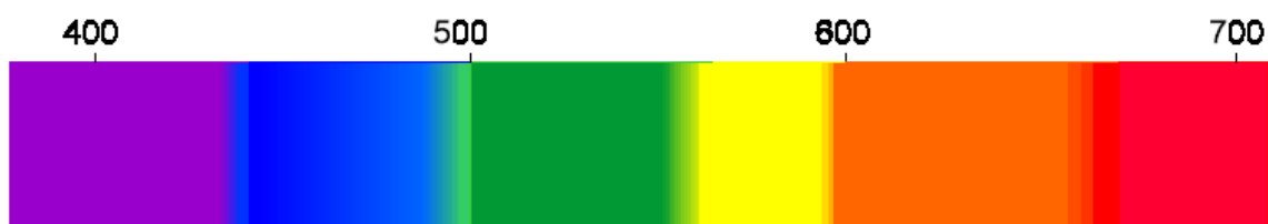
Figura 18 – Espectro visível pelo olho humano (comprimento de onda em nm) [Coelho, 2001]
