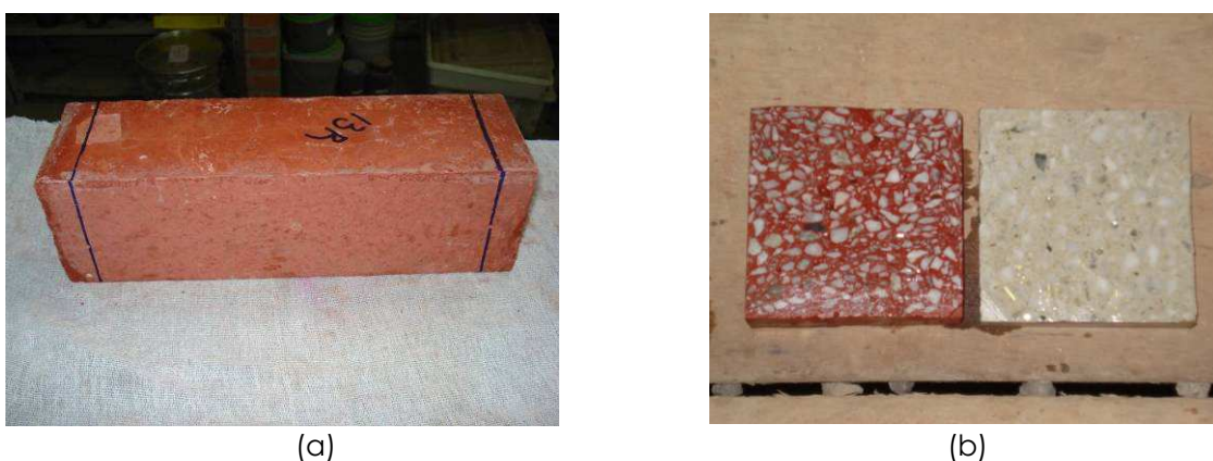
Figura 13 – (a) Corpo-de-prova antes de ser serrado; (b) Corpos-de-prova após serem serrados
