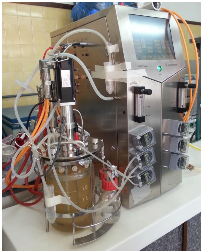
Figura 7 - Biorreator de 2L modelo BIOSAT B plus marca Sartorius Stedim.
