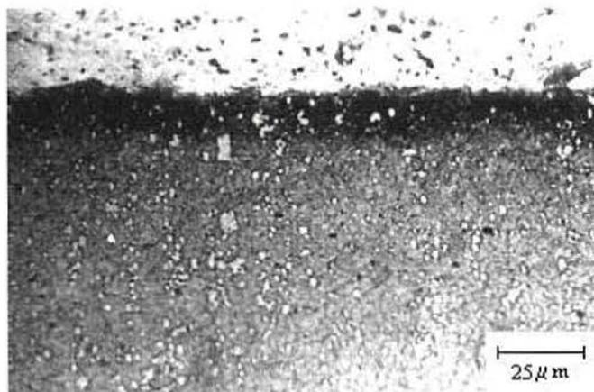
**Figura 4. 3** Aspecto micrográfico de camada nitretada em amostra “lixa 80”, obtida com a utilização da mistura gasosa de 5% vol.  $\text{N}_2$  em  $\text{H}_2$ , observada ao microscópio ótico . Ataque: reagente nital 2%. Amostra nitretada a  $500\text{ }^\circ\text{C}$  por 30 minutos (grupo II)
