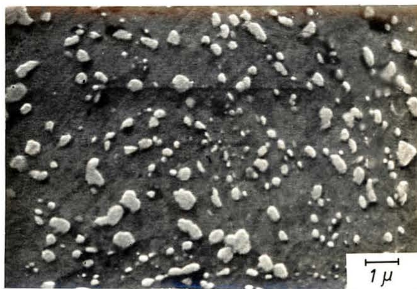
Fig. 14 - Aço esferoidizado (SAE 1045-E). Ataque picral 3%. Fotos em MEV.
