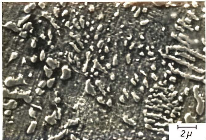
Fig. 11 - Aço parcialmente esferoidizado (SAE 1045-B). Ataque nital 3%. Fotografias em MEV.
