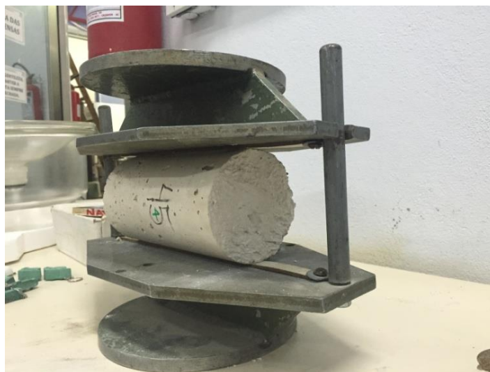
Figura 12 – Ensaio de tração por compressão diametral
