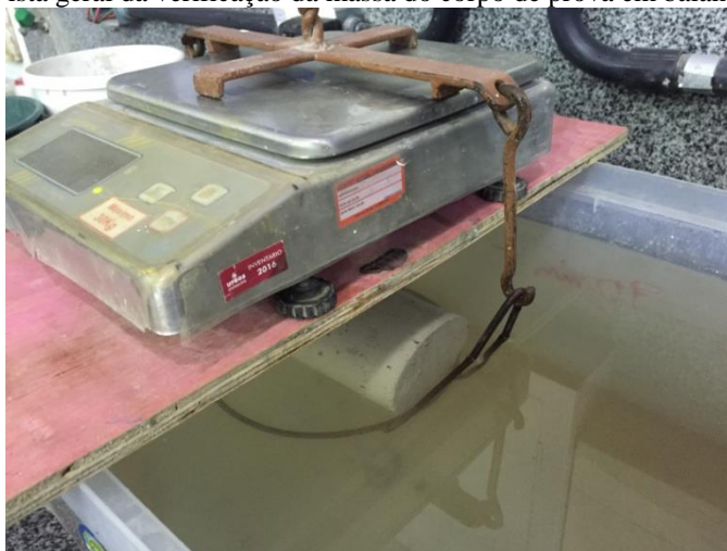
Figura 14 – Vista geral da verificação da massa do corpo de prova em balança hidrostática
