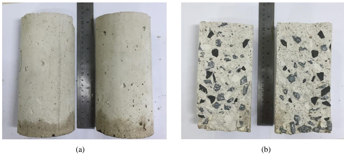
Figura 20 – Análise visual do perfil de umidade (a) lado externo do CP; (b) lado interno
