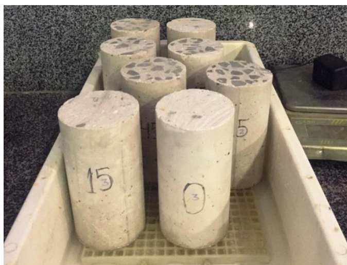
Figura 13 – Ensaio de absorção por capilaridade
