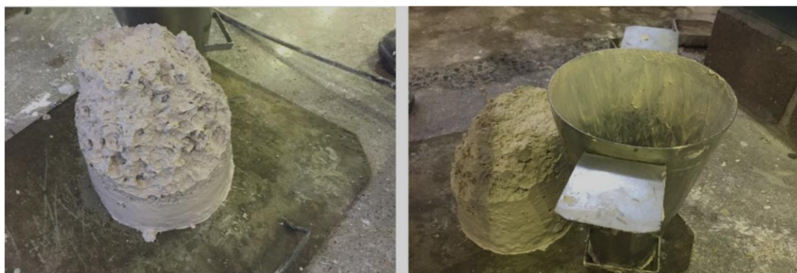
Figura 9 – Ensaio de abatimento de cone ( slump test )(a) cone após a remoção (b) medição da altura do abatimento
