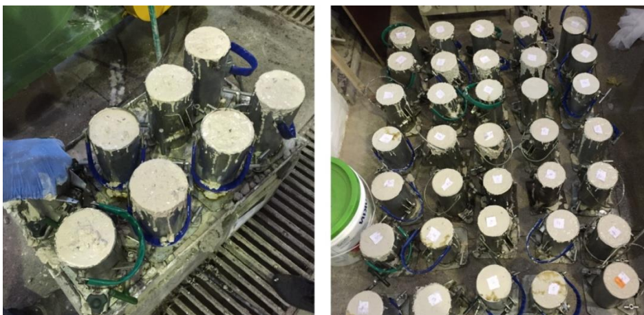
Figura 10 – (a) CPs sendo vibrados e (b) realocados em local adequado após moldagem
