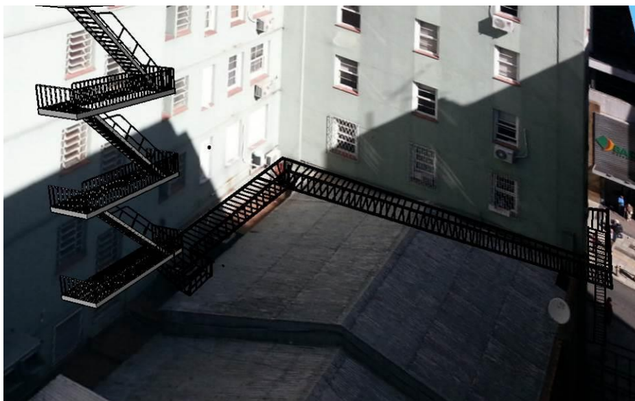
Figura 25 – Proposta de escada externa no edifício
